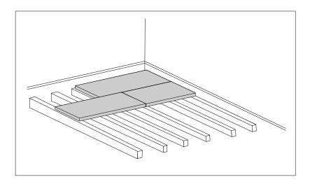
Figure 6.2: Pose des panneaux en plancher porteur.
