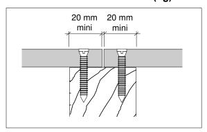
Figure 6 : Largeur d'appui des panneaux sur le support : au moins 20 mm.
