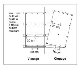
Figure 6.3. : Fixation des panneaux en plancher porteur.
