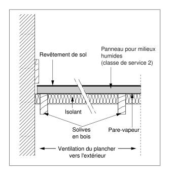
Figure 6.1. : Conception d'un plancher soumis à des risques d'humidification.
